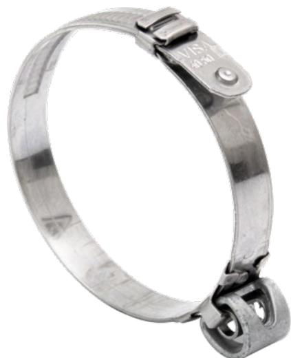
La versione VISA E, dotata di molla, garantisce il mantenimento della forza di serraggio, compensando variazioni di diametro causate da sbalzi di temperatura, pressione e vibrazioni. Le fascette a rottura calibrata assicurano un serraggio corretto grazie al controllo visivo del fusibile dopo il taglio del nastro, mentre la superficie interna liscia distribuisce uniformemente il carico radiale a 360°.
