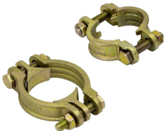
Collare DIN 20039 A in ghisa malleabile, realizzato in due parti, completo di bulloni, dadi e distanziatori; utilizzato per i collegamenti aria compressa in edilizia, cave, miniere ecc..
