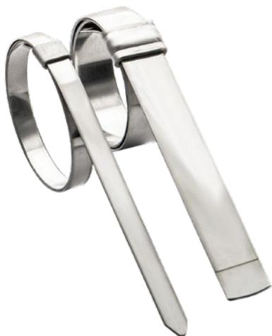
Fascette a diametro fisso, impiegate dove è richiesta una elevata tenuta e resistenza alle vibrazioni. Il sistema di ancoraggio della grappa e la superficie interna del nastro senza asperità permette la distribuzione del carico radiale a 360°.
