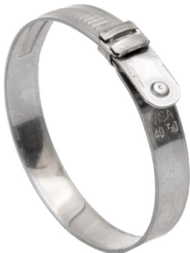
Le fascette a rottura calibrata garantiscono il corretto serraggio tramite il controllo visivo del fusibile dopo il taglio del nastro; la superficie interna del nastro senza asperità permette la distribuzione del carico radiale a 360° su tutta la circonferenza.
