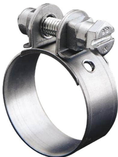
I collari tipo "S" permettono un'aderenza perfetta su tutta la circonferenza, grazie alla speciale conformazione del ponte che garantisce una tenuta a 360°. Il bullone ingaggiato direttamente nel filetto permette di stringere i collari con utensili pneumatici ed elettrici.
