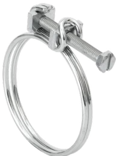
Fascette utilizzate per il serraggio di tubazioni flessibili tessili o PVC leggero e con spirali in rilievo negli impianti di climatizzazione e trattamento aria, su tubi alluminio per evacuazione fumi e su tubi in gomma morbida.
