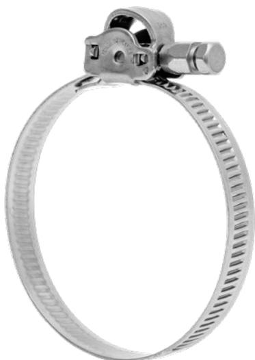
Fascette con rottura calibrata della vite, che si stacca in fase di serraggio al raggiungimento del valore di coppia prefissato. Assicurano una tenuta perfetta a temperature comprese tra -40°C e +130°C; il sistema a molla mantiene costante la coppia di serraggio per compensare variazioni diametrali causate da escursioni termiche.
