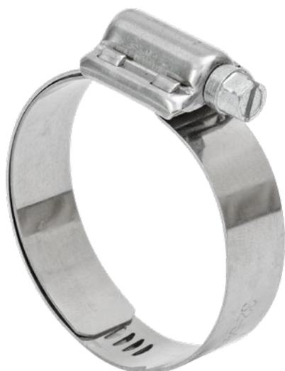
Fascette con elevata coppia di serraggio, superiore alle comuni fascette stringitubo con vite; la robustezza del cassetto a 4 pezzi e la vite in presa su 8 denti della cremagliera le rendono indicate per applicazioni con alte pressioni e forti vibrazioni.
